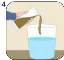
एक बाल्टी में नापा हुआ सीमेन्ट टॉनिक एलडबल्यु+ और शेष गोजिंग पानी अच्छी तरह से हिलाएं।
